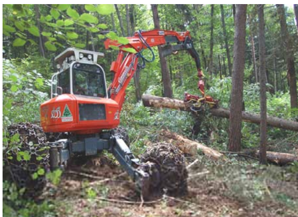
Utilizzo del processore per l’allestimento del legname tagliato (Disino, Niardo)
